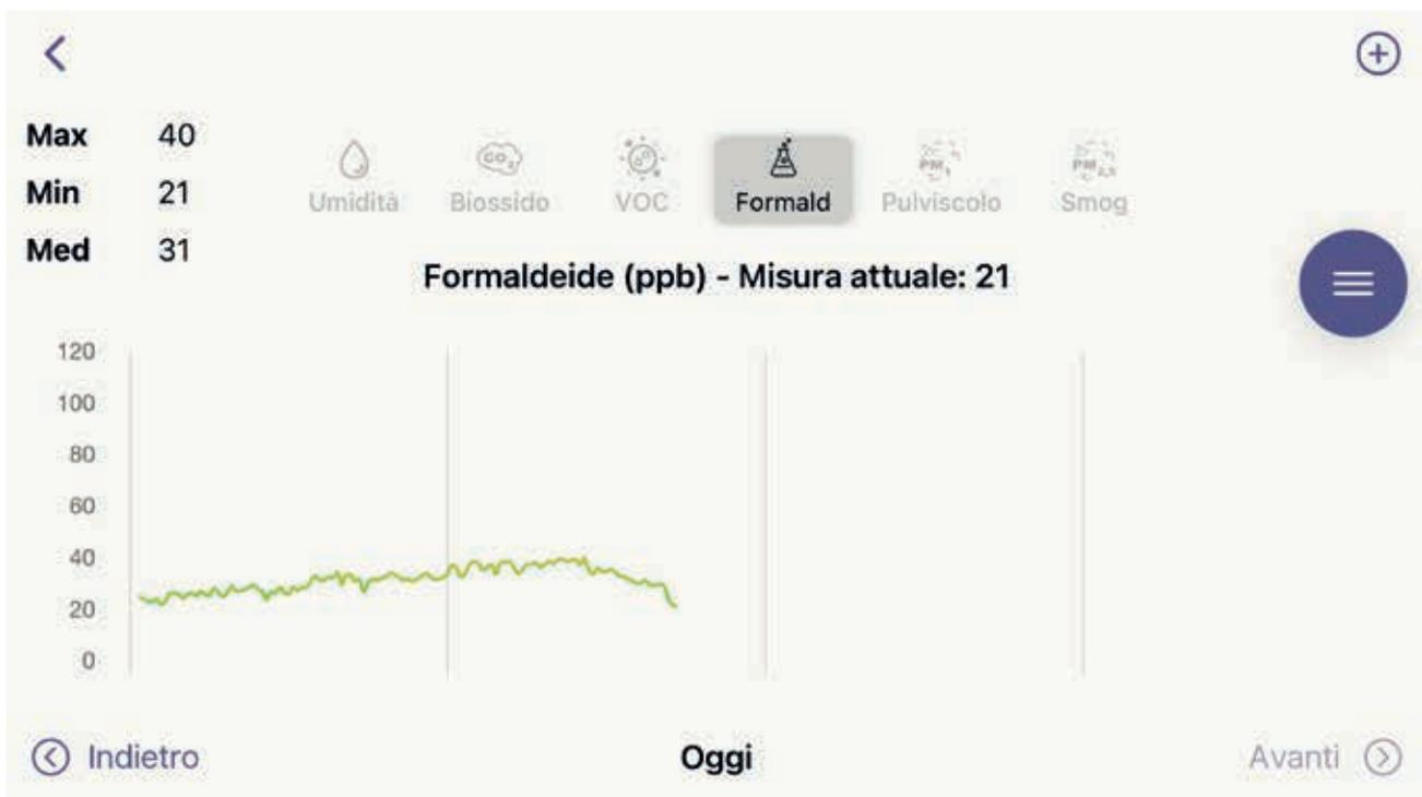
Esempio di monitoraggio continuo della formaldeide presente all'interno di un'aula scolastica dotata di un sistema di VMC perfettamente dimensionato secondo norma UNI 10339. L'andamento è suscettibile di variazioni sensibili (20-40 ppb) senza mai arrivare a livelli accettabili, ovvero inferiori a 10 ppb. (Fonte Biosafe)
